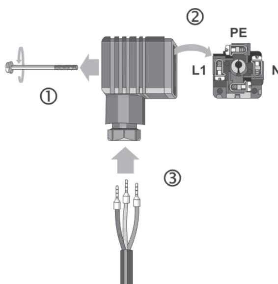
Raccorder le câble électrique à la prise mâle de l'appareil
