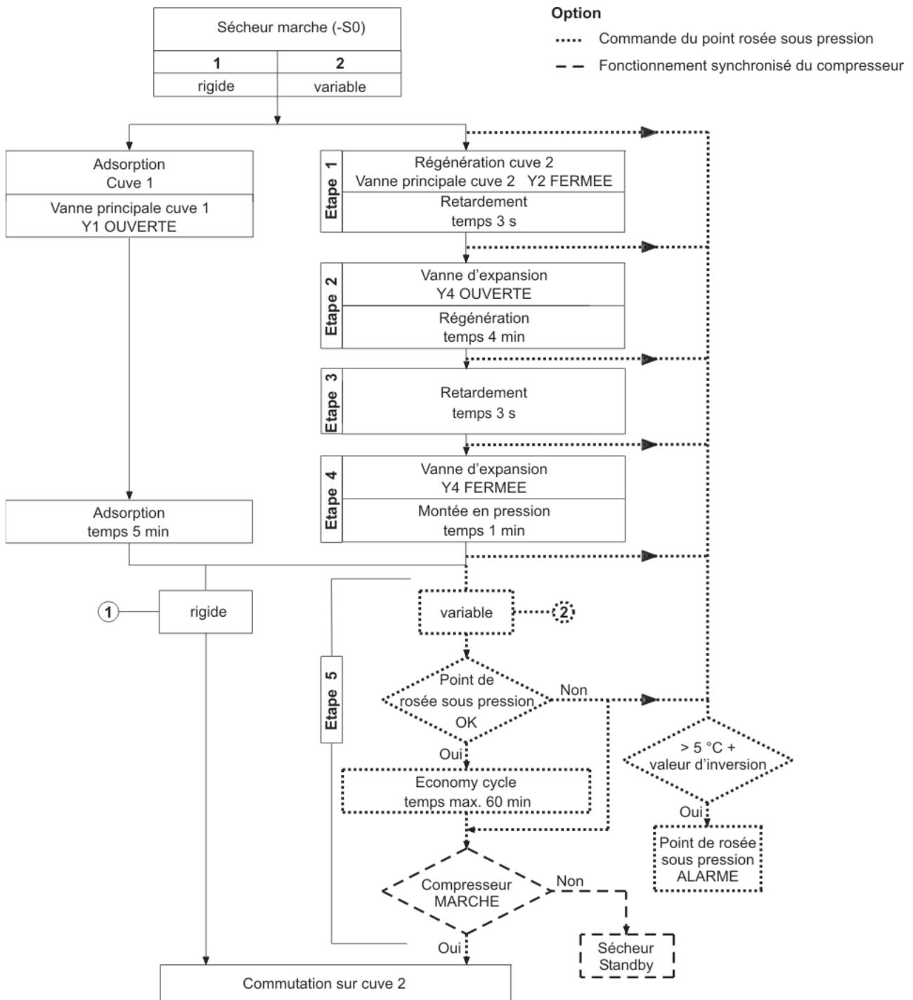
Régénération dans B1 et adsorption dans B2
